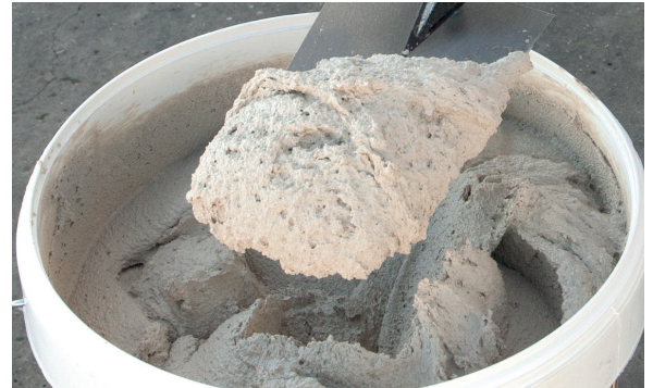
2. Extraer el PX-28 Isolxtrem SILOXANE TECHNOLOGY L con la ayuda de una paleta.
