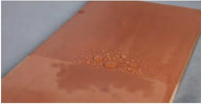
Los materiales tales como rasilla, morteros y baldosas que componen las terrazas y azoteas, no son impermeables por sí mismos, caracterizándose por un muy alto grado de absorción. En la foto nº 1 se puede observar cómo la parte no hidrofugada de la rasilla absorbe el agua hasta saturación.
