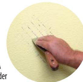
1. Vérifier l'état de la gouttelette en place en réalisant un test de quadrillage comme expliqué ci-dessous. (voir paragraphe BON À SAVOIR). Si le support est consistant, procéder selon nos recommandations suivantes.
