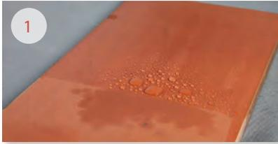
Les divers matériaux qui composent les terrasses et les toitures tels que les briques, le mortier ou les tuiles ne sont pas imperméables et se caractérisent par un degré d'absorption très élevé. Dans la photo n° 1, nous pouvons observer comment la partie non traitée de la tuile absorbe l'eau jusqu'à saturation.
