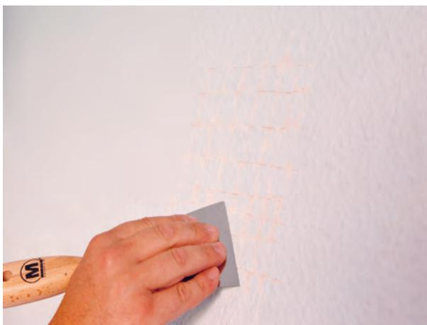
Se il fondo non presenta cavità, ed ha superato la prova della quadrettatura, possiamo applicare direttamente Rualaix +confort 2 in 1, senza temere l'apparizione di patologie più tardi.
