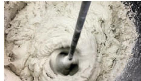
El cemento cola **CX-60 Colbaix® Univerflex**, tiene una vida útil de 3 horas. Pasado este tiempo, ya no podrá ser utilizado, pues si removiéramos la pasta para continuar empleándola, interrumpiríamos su curva de fraguado, produciendo alteraciones en su secado, resistencia y dureza superficial del mismo.
