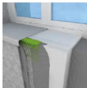
El perfil es de PVC con malla de fibra álcali-resistente.
