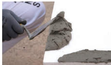
El mortero de encolado y enlucido **CX-28 Isolxtrem Poliestirex** tiene una vida útil de 2 - 3 horas. Pasado este tiempo ya no podrá ser utilizado, pues si removiéramos la pasta para continuar empleándola interrumpiríamos su curva de fraguado, produciendo alteraciones de secado, resistencias y dureza superficial del mismo.
