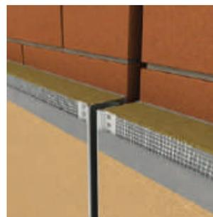
Junta de dilatación de fachadas en esquinas internas, corresponde a la junta de dilatación que nos encontramos en el encuentro entre dos fachadas. Esta junta se resolverá mediante el perfil junta de dilatación ángulo.
