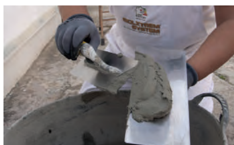
3. CX-28 Isolxtrem Poliesticirex, aspecto después de amasado
